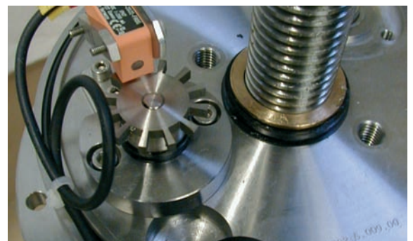
Präzises Dosieren: Die Dosys TM -Kolbenpumpe bietet eine Dosiergenauigkeit von +/-0,5 %.
