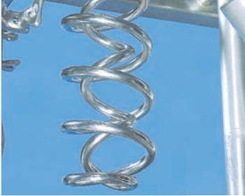
Die Spirale mit geringer Scherung (Low-Shear) sorgt für den Erhalt der Produkttextur und gleichmäßigen Fluss.
