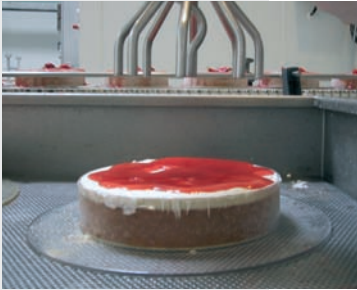
Genauige Dosierung eines sensiblen Himbeer-Gebäcküberzugs mit einem Mehrfachdüsensystem.
