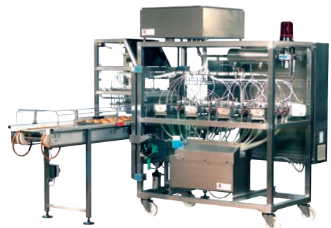
Das PCM-Abfüllsystem produziert bis zu 21.000 Rosinenbrötchen pro Stunde
